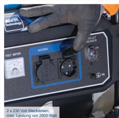
2 x 230 Volt Steckdosen, (max. Leistung von 2800 Watt)
